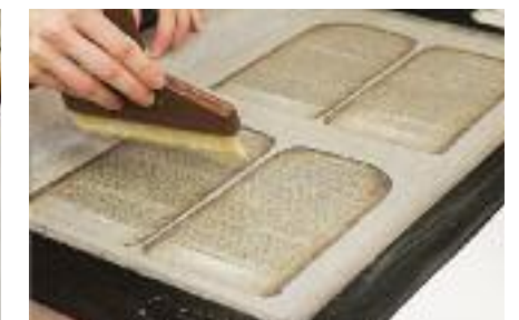
Abb. 7: Auftrag des Biopolymer-stabilisators.
